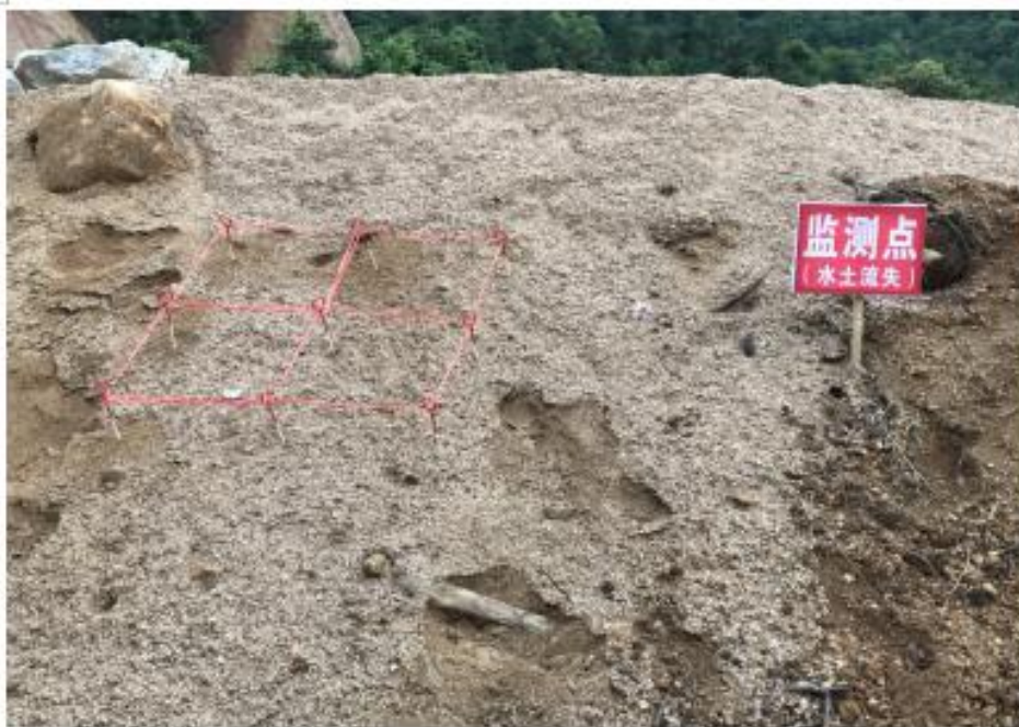
简易水土流失观测小区
